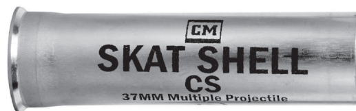
Pièce pyrotechnique « Skat Shell 37mm CS » de la compagnie Safariland, tirée avec un fusil 37mm. Les policiers l'utilisent pour projeter dans une foule 5 capsules de métal d'où se dégage du gaz lacrymogène CS.
